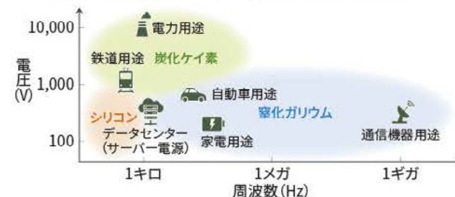
電圧・周波数特性でみる半導体材料の用途分布
